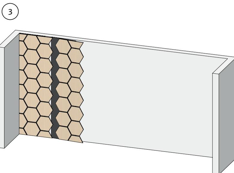
3. Asegúrese de que no haya restos de adhesivo en la pared existente antes de colocar los paneles SKARV. Doble primero el panel SKARV y, a continuación, empuje la última pieza para que los fieltros se unan. Asegúrese de presionar el panel contra la pared en toda la superficie para que el adhesivo se adhiera.
